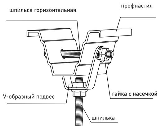
3. Схема использования шпилек и универсального поддерживающего профиля для монтажа кабельных трасс.
