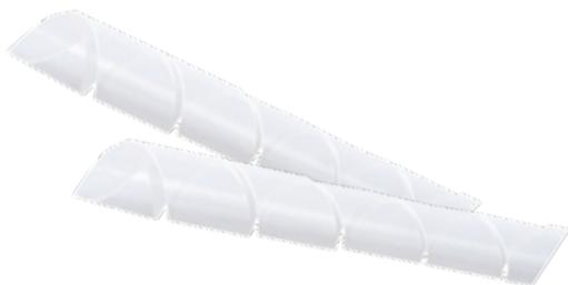
Лента спиральная монтажная SWB (spiral wrapping band) применяется для объединения кабелей в трассы, вязки в жгуты и разводки проводов, защиты кабелей от трения и механических повреждений. Лента производится из полиэтилена высокого давления с добавлением компонентов, препятствующих горению. Поставляется рулонами по 10 м.
