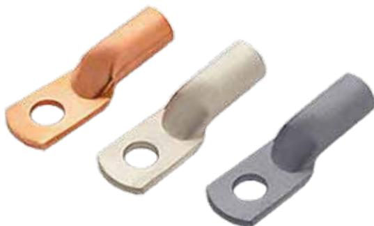
Силовые наконечники используются для оконцевания проводов и кабелей с медными и алюминиевыми жилами посредством опрессовки для последующего болтового соединения проводника с оборудованием или шиной.
