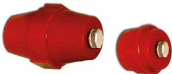
Шинные изоляторы серии SM применяются для крепления токопроводящих шин внутри силовых шкафов или других устройств, для неподвижной фиксации и изоляции частей находящихся под напряжением от корпуса и панелей сборки с последующим подключением силовых проводников для распределения электроэнергии внутри щита. Крепление шинного изолятора осуществляется с помощью болта и шайбы, входящих в комплект поставки, к монтажной пластине или корпусу — с одной стороны, и токоведущей шине — с другой.
