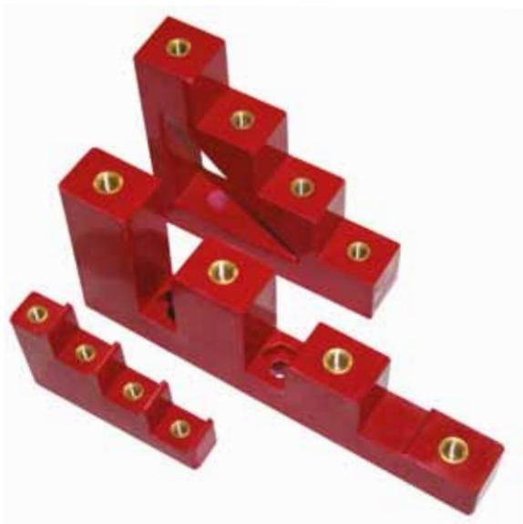
Изоляторы шинные опорные «Лесенка» применяются для крепления, фиксации и изоляции токопроводящих шин внутри электрических щитов и другого оборудования. Крепление изолятора осуществляется с помощью болта и шайбы, входящих в комплект поставки, к монтажной пластине или корпусу – с одной стороны, и токоведущей шине – с другой
