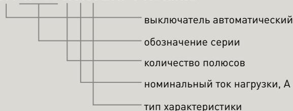
Автоматические выключатели ВА 47-63 4,5кА EKF PROxima предназначены для оперативного управления участками электрических цепей, а так же защиты от токов перегрузки и короткого замыкания в административных, промышленных и жилых зданиях. Выключатели производятся в одно-, двух-, трех- и четырехполюсном исполнении.
