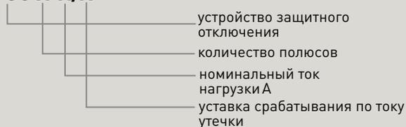
Устройства защитного отключения (УЗО) предназначены для защиты человека от поражения электрическим током при прикосновении к открытой проводке или к электрооборудованию, оказавшемуся под напряжением, и для предотвращения возгорания, возникающего вследствие длительного протекания токов утечки и развивающихся из них токов короткого замыкания.
