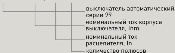
Выключатели автоматические серии BA-99 предназначены для нечастых оперативных включений и отключений тока в нормальном режиме, а также защиты от токов перегрузки и коротких замыканий распределительных сетей и электродвигателей. Выключатели могут применяться в электроустановках с номинальным напряжением до 400 В переменного тока частотой 50 Гц с токами от 12,5 до 1600 А. Выключатели BA-99 имеют шесть исполнений корпуса.
